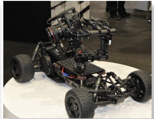
Колесная дистанционно управляемая платформа с двигателем для мобильной съемки
